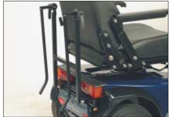
9. Manuaalipyörätuolin pidike, taakse asennettava. Maksimi kuormitus 20 kg. (Art. no. T-127-06-131).
