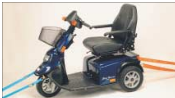
13. Kiinnityshihnasarja Mini Crosseria varten. Pituus 35-68 cm. Vetolujuus 25000 N/hihna. (Art. no. T-127-06-146).
