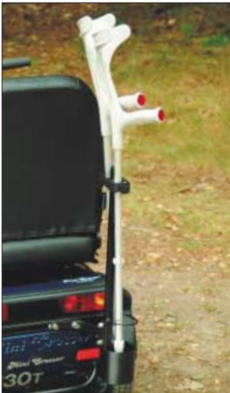
3. Kynänsauvan pidike, 2:lle sauvalle. (Art. no. T-127-06-150). 4-pistekepin pidike. (Art. no. T-127-06-151).
