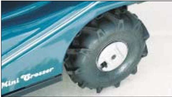
37. Rengas, maastokuviointi, 125-T, 130-T ja 140-T -malleihin. (Art. no. T-127-03-058). Nastarengas. (Art. no. T-127-03-059).
