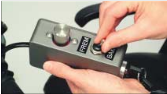
1. Mini Crosserin kaukosäätö. Eteenpäin/peruutus ja nopeudensäätö. (Art. no. T-127-06-113).
