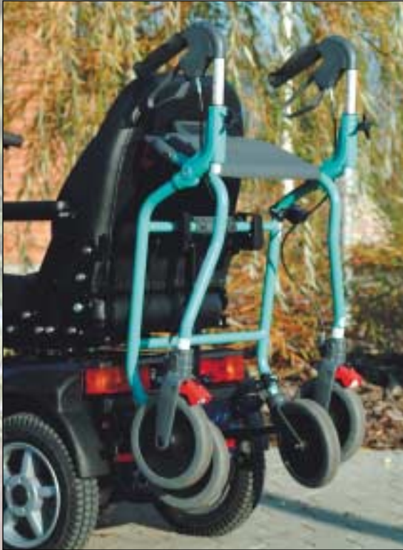
7. Rollaattorin pidike. Maksimi kuormitus 20 kg. (Art. no. T-127-06-139).
