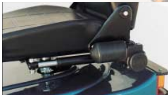
42. Sähköinen istuimen säätö, 10 cm. (Art. no. T-127-07-045).
