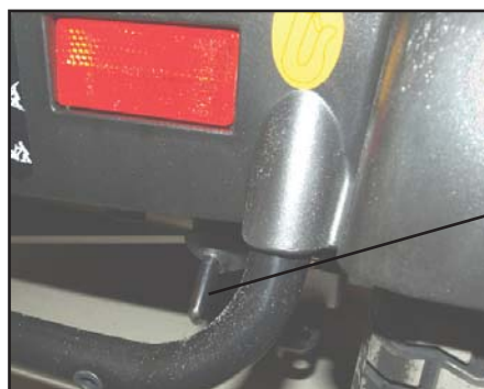
Kuva 11 Mopedi kytketään vapaalle työntämällä vapaallekytkentävipu al asentoon (vain käsijarru toimii). Kun vipu työnnetään yläasentoon, moottori aktivoituu jälleen (mopedilla voidaan ajaa nyt normaalisti).
