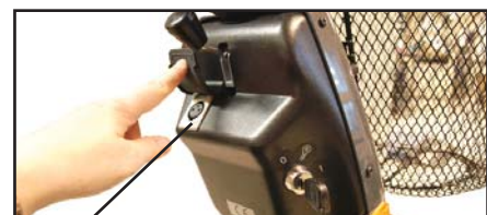
Latauspistoke liitetään ohjauspylvään kolminapaiseen latausliitäntään. Latausliitäntä on suojalevyn alla.
