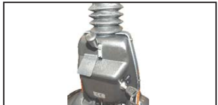
La prise de charge est reliée à une prise tripolaire sur le montant du guidon. La prise de charge se trouve sous la plaque de protection.
