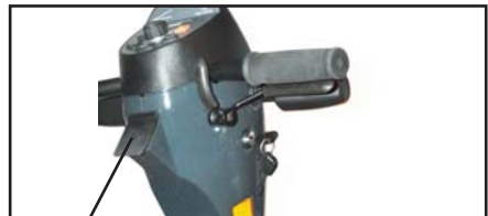
De laadstekker wordt aangesloten op een 3-polige steekker in de stuurkolom. De laadstekker zit onder de beschermplaat.
