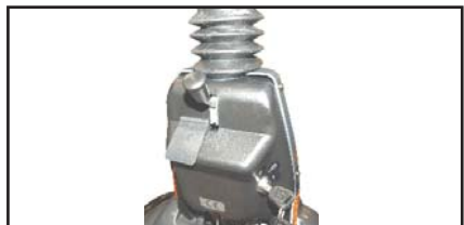
De laadstekker wordt aangesloten op een 3-polige stekker in de stuurkolom. De laadstekker zit onder de beschermplaat.
