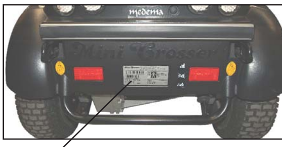
Plaatsing van serienummerplaatje op voertuig.
