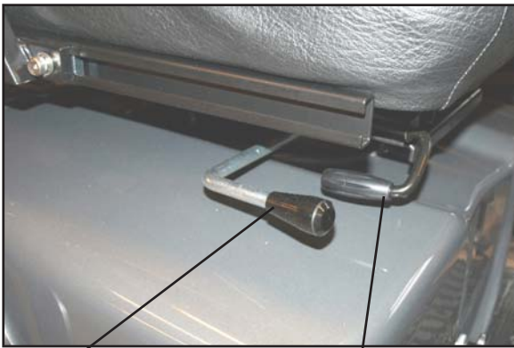
Ontgrendeling voor stoel draaien. Ontgrendeling voor stoel vooruit/achteruit.
